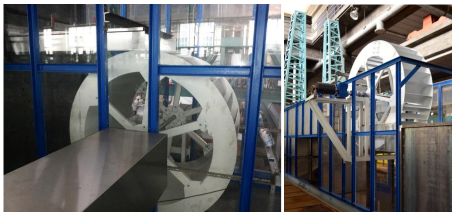
Figura 6. Ruote overshot e breastshot studiate nel laboratorio di Idraulica del Politecnico di Torino.
